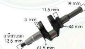
■ HG5.5-07 Crank shaft ข้อเหวี่ยง
